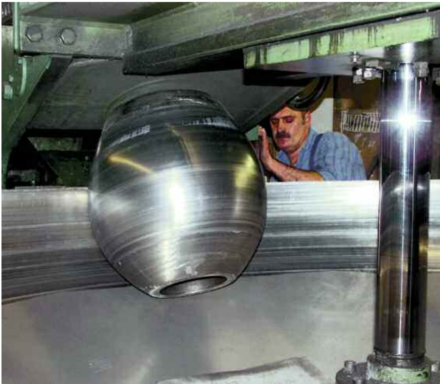
Spinning of an aluminium tank-end (König)
